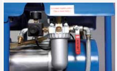
Druckminderer mit Manometer und Frostschutzeinrichtung Pressure regulator with manometer and anti-freeze device
