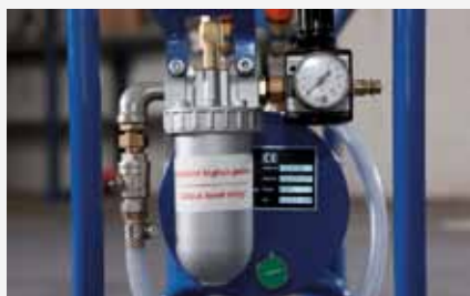
Druckminderer mit Manometer und Frostschutzeinrichtung Pressure regulator with manometer and anti-freeze device
